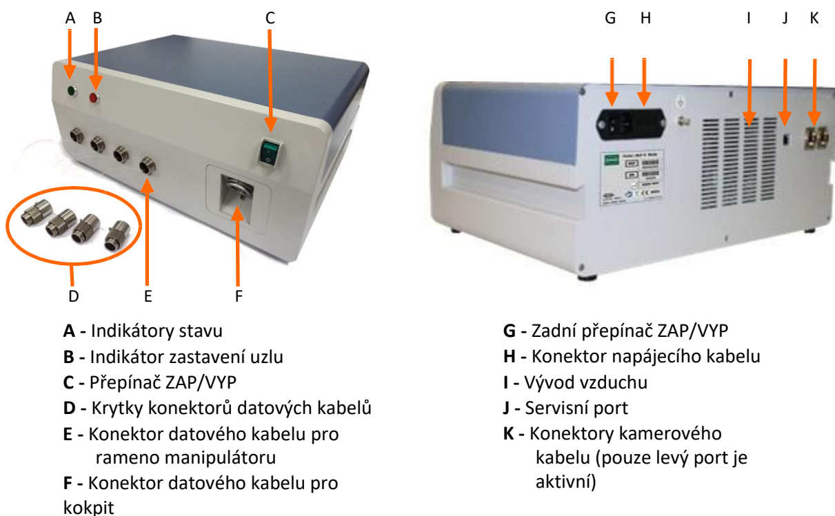
Obrázek 4-36. Uzel a hlavní komponenty
