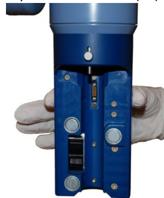
Obrázek 5-7. Prsty tisknoucí obě polohovací tlačítka (B7)
