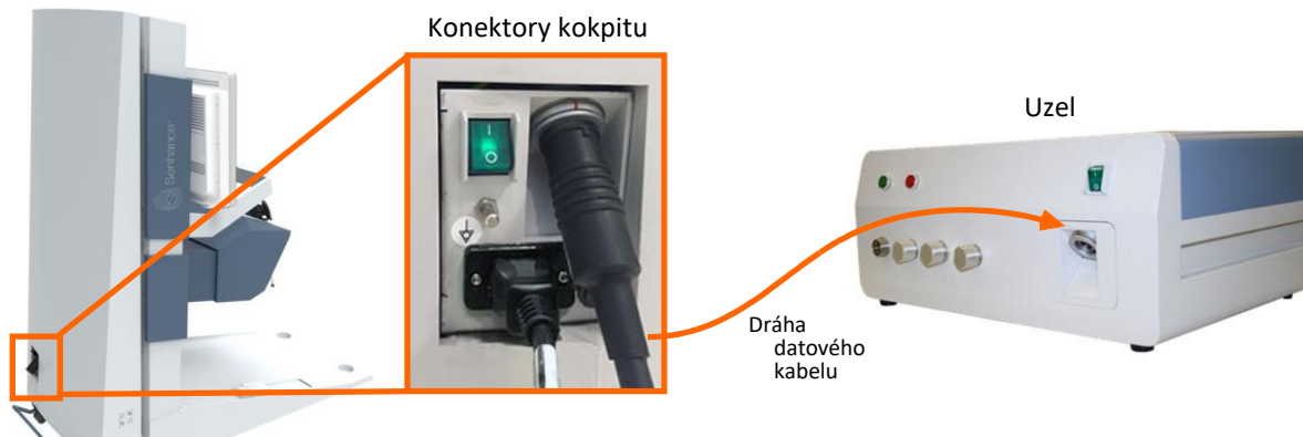
Obrázek 5-2. Trasa datového kabelu z kokpitu k uzlu
