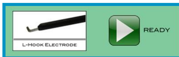
Obrázek 4-13. Indikátor stavu pro rameno manipulátoru přiřazeného k vybrané rukojeti
