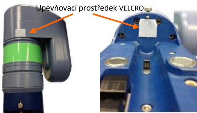
Obrázek 5-11. Správná poloha upevňovacích prostředků VELCRO na rozhraní nástroje
