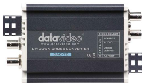
Obrázek 15-1. Data video DAC-70 a páčkové přepínače
