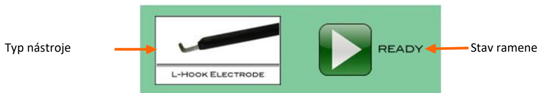
Obrázek 4-12. Indikátor stavu ramene manipulátoru přiřazeného k rukojeti
