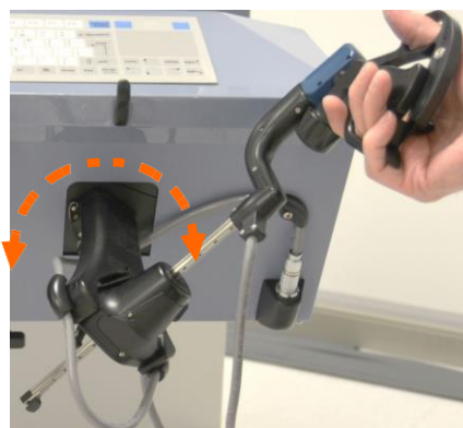
Obrázek 7-6. Boční pohyb na monitoru s koordinačním úhlem 75^\circ
