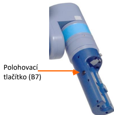
Obrázek 5-6. Polohovací tlačítka (B7) na rozhraní nástroje
