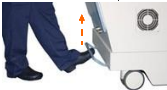
Obrázek 4-35. Uvolnění brzdy koleček
