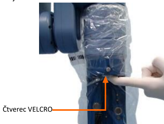
Obrázek 5-11. Správná poloha upevňovacích prostředků VELCRO na rozhraní nástroje
