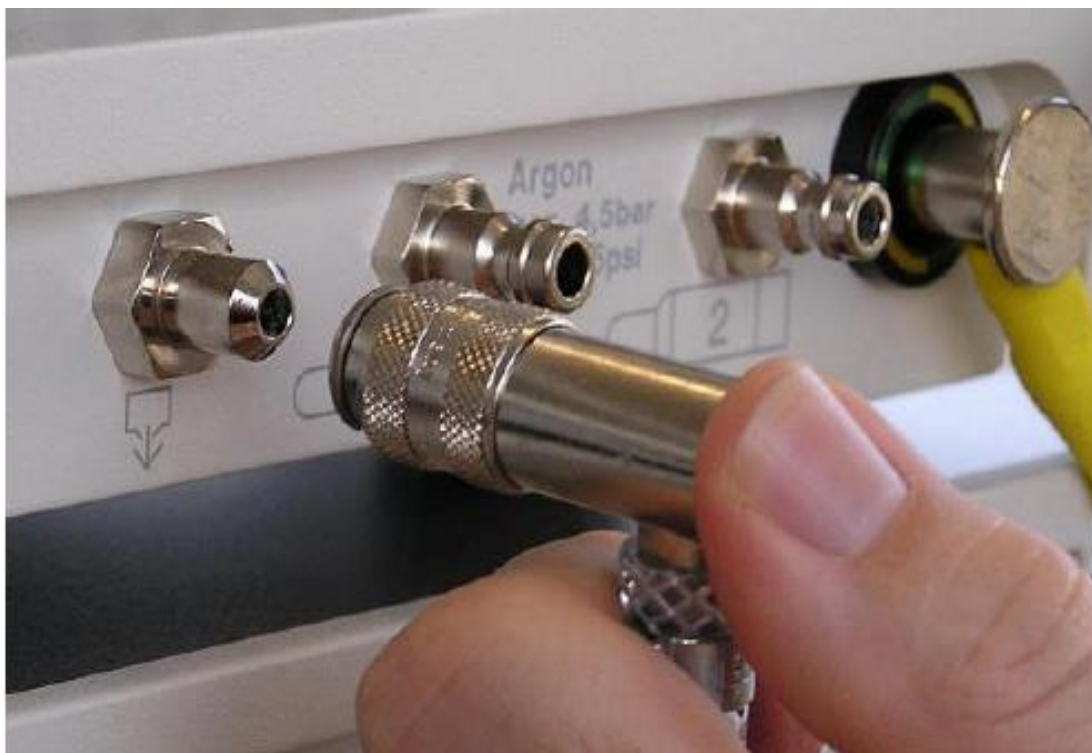
Obr. 20 - Vyprazdňování vedení z plynové lahve s argonem do jednotky arcplus
