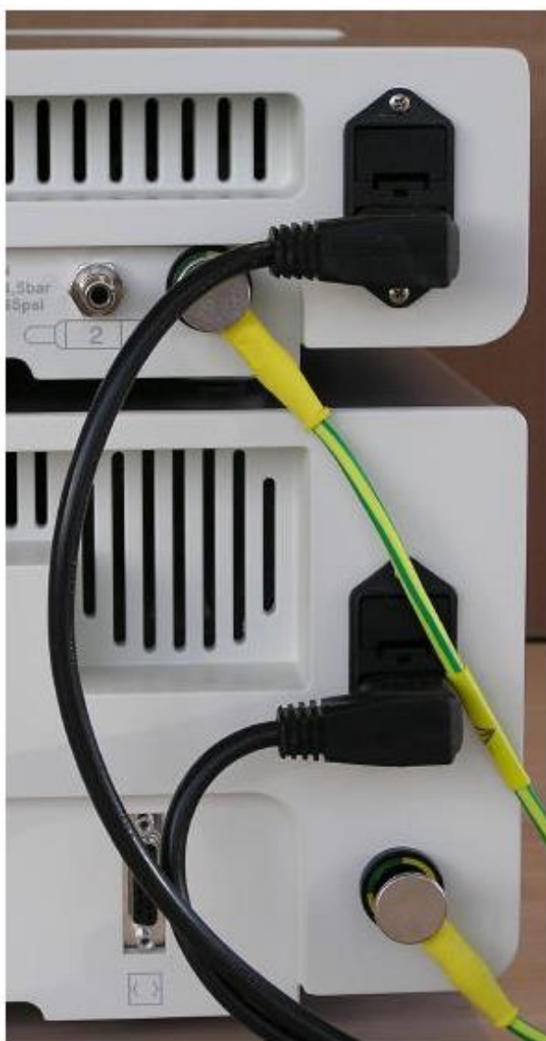
Obr. 2 - Síťový kabel a PE přívody na generátoru arc a jednotce arc plus
