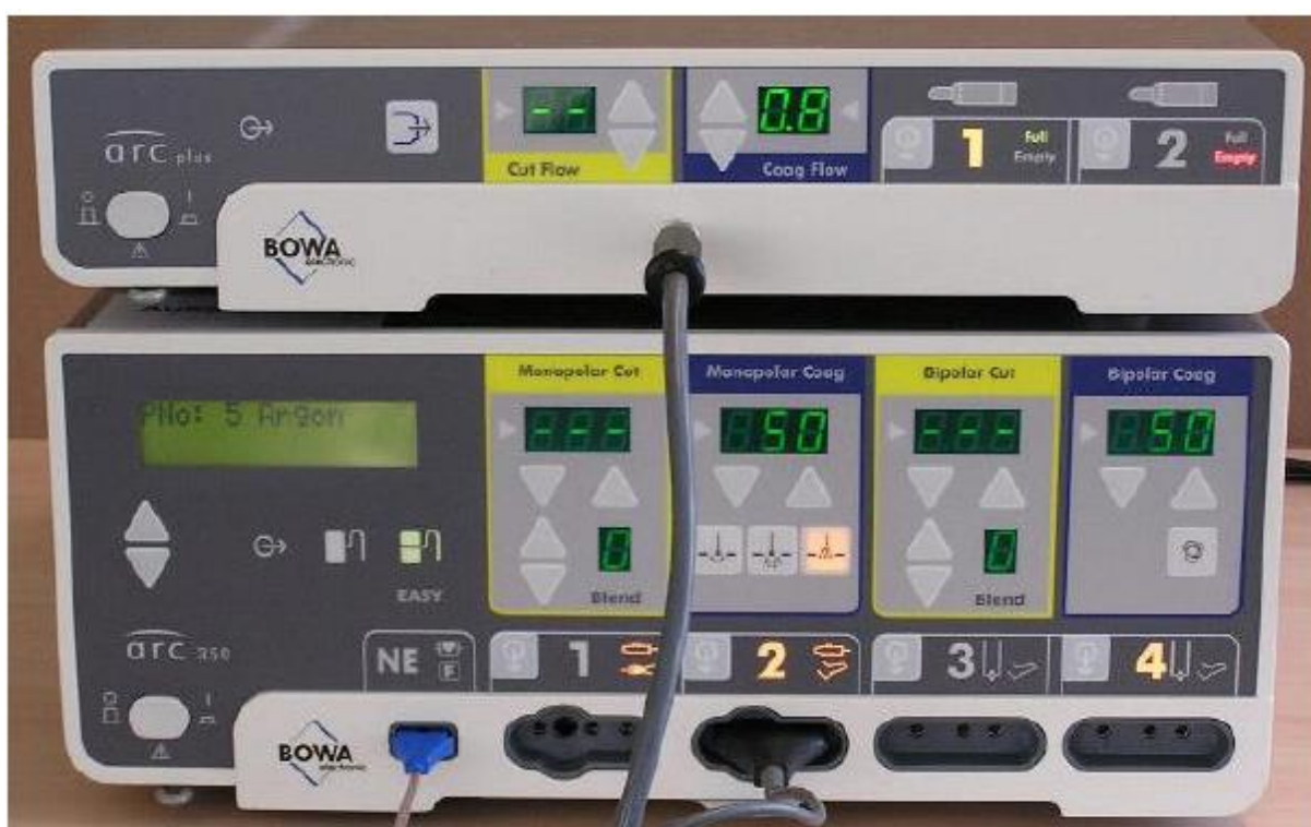
Obr. 14 - Připojení pružné argonové sondy
