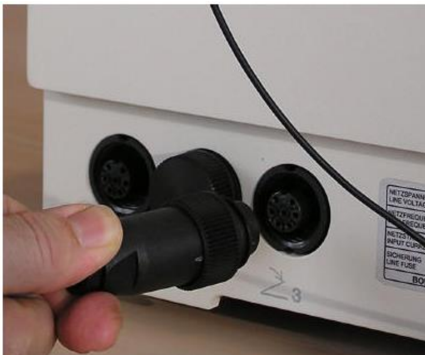
Obr. 7 - Připojení dvojitého pedálového spínače k vysokofrekvenčnímu generátoru arc 350 nebo arc 300
