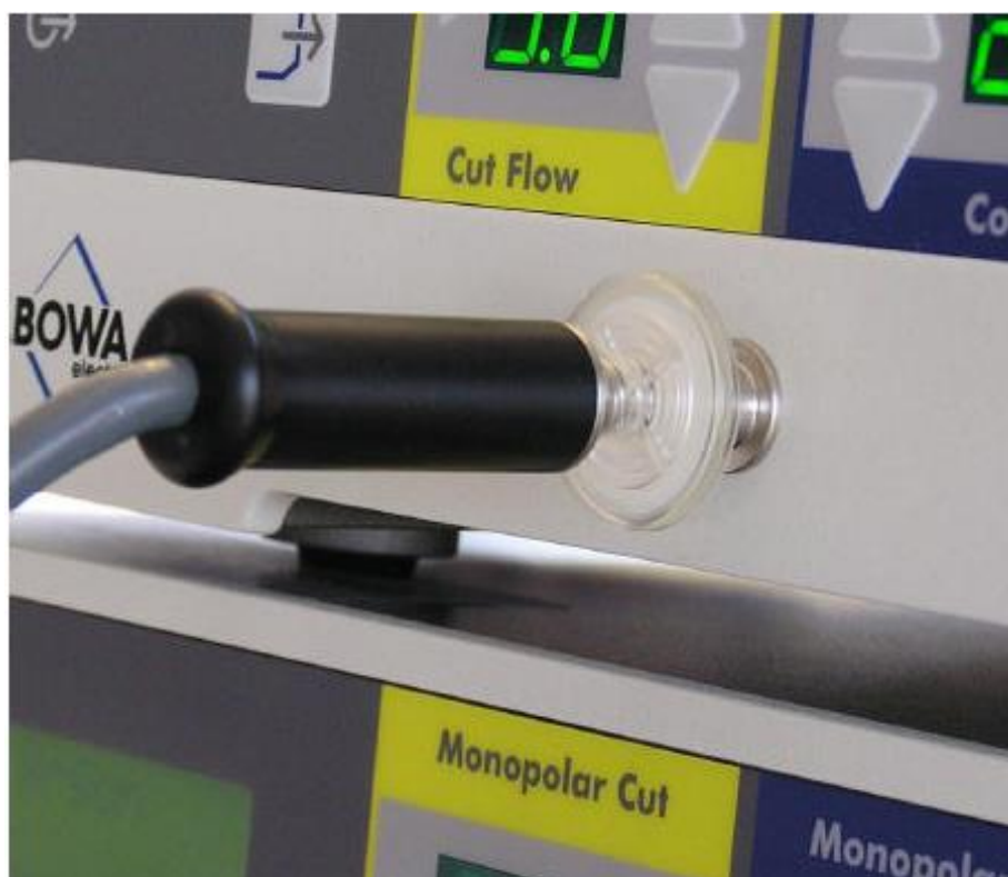
Obr. 17 - Sterilní filtr mezi propojovacím kabelem a jednotkou arc plus
