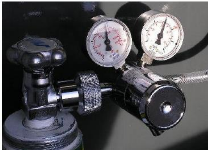
Obr. 9 - Nastavení tlaku, primární a sekundární
