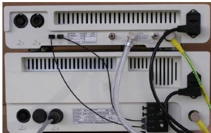
Obr. 10 - Všechny přípojky na zadní straně jednotky arc plus a na vysokofrekvenčním regulátoru
