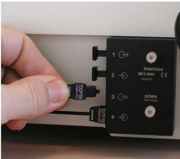
Obr.4-Optické kabely na komunikačním rozhraní
