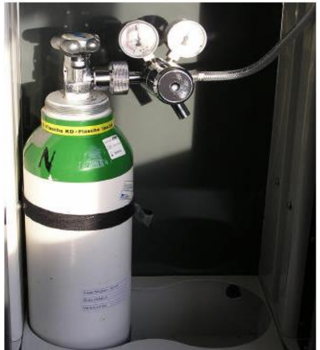
Obr. 1 - Připojení argonové láhve na vozíku zařízení
