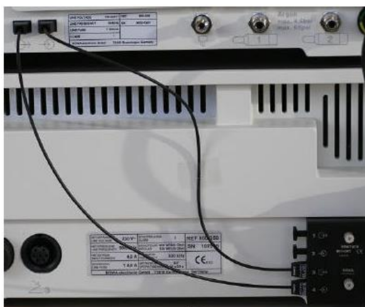
Obr.6-Vysokofrekvenční generátor, připojený k jednotce arc plus přes komunikační rozhraní
