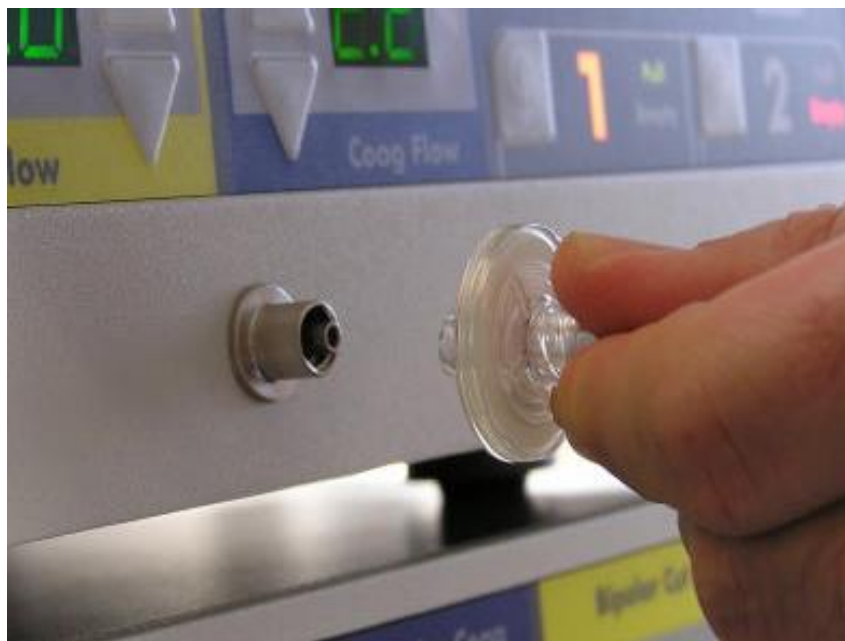
Obr. 16 - Připevnění sterilního filtru k jednotce arc plus
