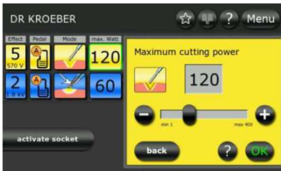
Obr. 5-7: Mezní hodnota výkonu u monopolárního řezání
