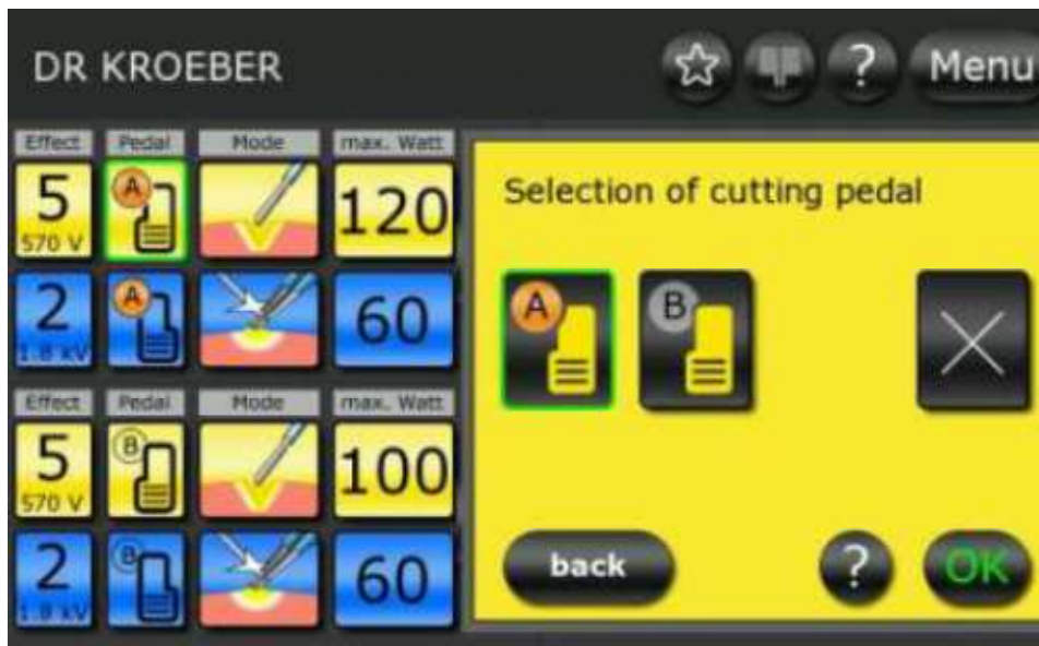
Obr. 5-9: Řezání s výběrem nožního spínače
